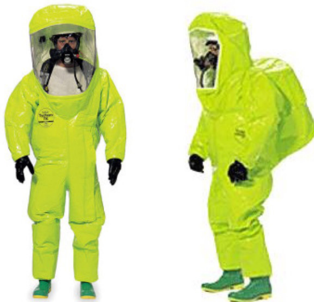
รูปที่ 6.9 การปกป้องระดับ A ชุดปกป้องที่ห่อหุ้มร่างกายทั้งหมด ซึ่งกันไอระเหย พร้อมหน้ากากเต็มหน้า และ SCBA หรือแบบที่มีอากาศส่งเข้ามาในหน้ากาก
