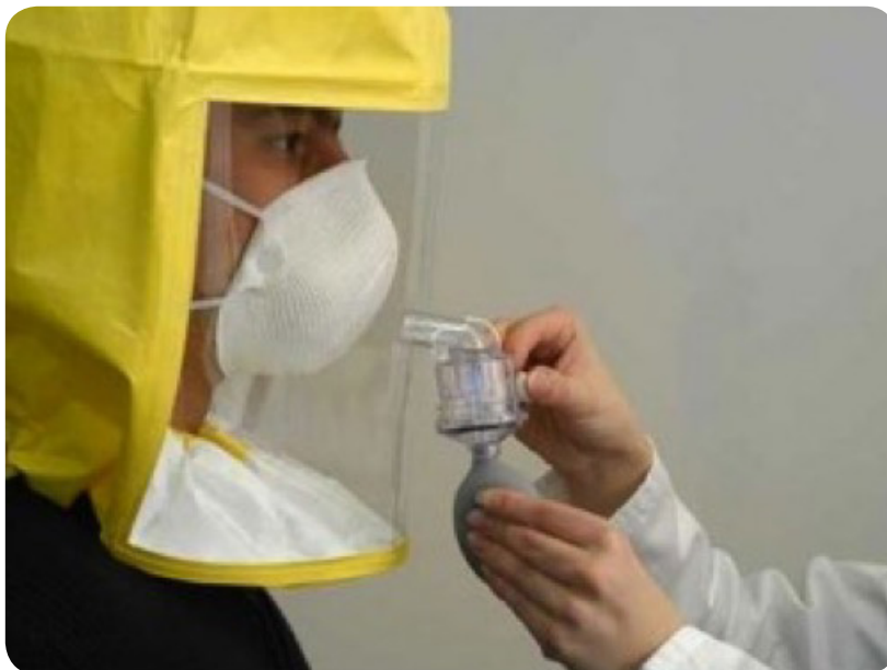
รูปที่ 6.8 การทดสอบความพอดีทางคุณภาพ (Qualitative fit testing)
